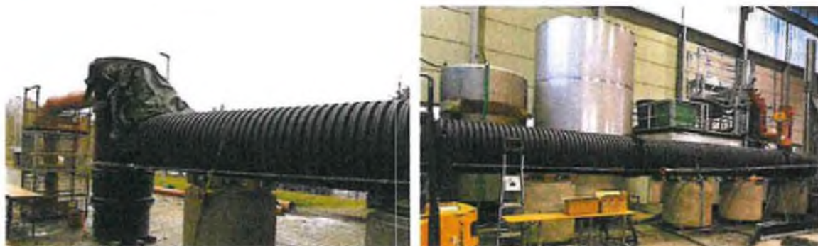
Abb. 3: Niederschlagswasserbehandlungsanlage Certaro 800/21 „begehrbar“ aufgebaut im IKT-Prüfstand während der Versuchsdurchführung mit Blick (links) auf den Anlagenteil außerhalb der Halle mit Auslauf und Probenahmestelle und Blick (rechts) auf die Zudosierung in der Versuchshalle.
