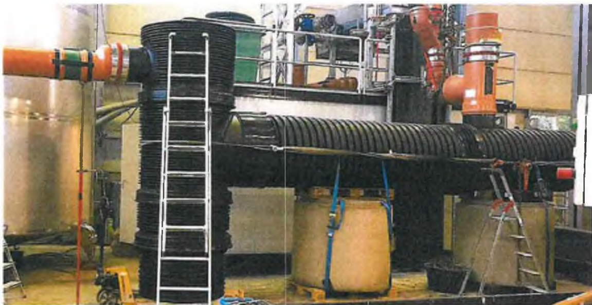
Abb. 2: Niederschlagswasserbehandlungsanlage Certaro 800/6 „begehrbar“ aufgebaut im IKT-Prüfstand während der Versuchsdurchführung.
