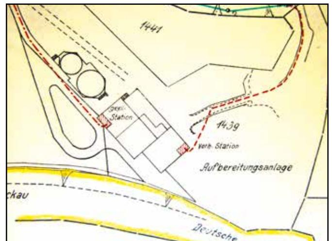
Lageplan der Aufbereitung am Plohnbach in der Zeichnung für die Starkstromleitung vom August 1942
